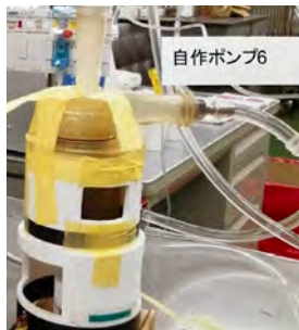
自作ポンプ6 インペラを内蔵した遠心ポンプ、上が血液の入り口、右が出口
